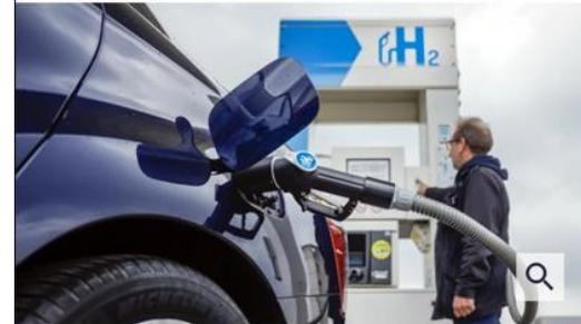
Ein Toyota Mirai an einer Wasserstofftankstelle. Wenn die Säule funktioniert, ist der 700-Bar-Drucktank in wenigen Minuten voll. (Foto: Rupert Oberhäuser/imagomages)
