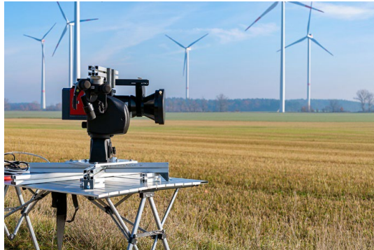
EvalTherm – Passive Thermografie für Rotorblattschäden an Windenergieanlagen,
